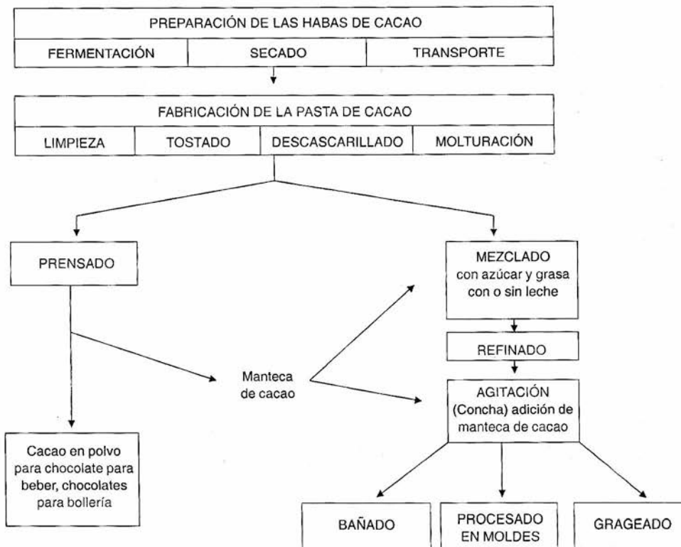
Figura 1.4 Diagrama esquemático de los procesos de fabricación del chocolate.
