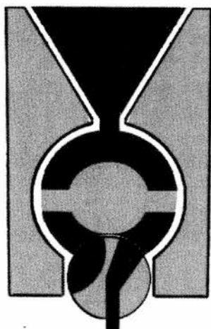
Figura 7.4 Diagrama de un sistema de depósito de tipo pistón para depositar una cantidad determinada de chocolate en un molde.
