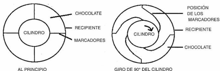
Figura 8.7 Flujo entre el recipiente y el cilindro en un viscosímetro de cilindros coaxiales.
